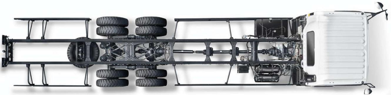
Chassis Isuzu GIGA FVZ dilengkapi dengan body mounting hole yang mampu memudahkan proses serta mempersingkat waktu pembuatan dan pemasangan karoseri.
